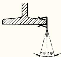
Une inclinaison de 15 degrés au maximum par rapport à l'axe vertical est acceptable.
