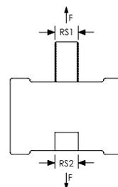
Matériau: Acier; Caoutchouc EPDM-SDR
