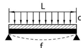
\* Toutes les capacités de charge sont exprimées en NEWTON (N). La capacité nominale du profil de montage (F) a été calculée dans le cas d'une charge uniformément répartie et inclut un facteur de perçage de 0,92 ; elle dépend de la limite élastique du matériau et de la déformation maximale admissible, un facteur de sécurité supplémentaire de 2 est recommandé. Pour une utilisation en intérieur uniquement.
