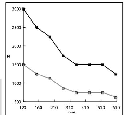
Toutes les capacités de charge sont exprimées en NEWTON (N). La charge calculée à partir d'une contrainte admissible est basée sur la limite élastique du matériau, un coefficient de sécurité supplémentaire égal à 2 est donc recommandé.
