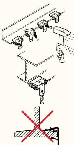
N'insérer aucun composant secondaire entre la poutre et l'attache nVent CADDY.
