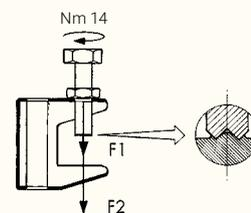
L'acier à haute résistance à la traction du boulon de classe 8.8, norme EN ISO 898-1
