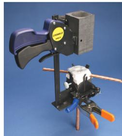
**ETAPE 1** Empiler les joints et les conducteurs à souder dans le moule. (Préchauffer le moule avant la première soudure).
