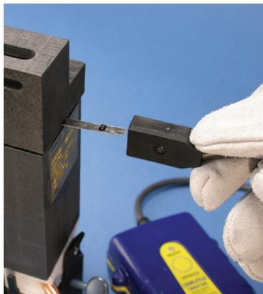
**ETAPE 3** Fermer le couvercle et connecter l'allumeur électronique.
