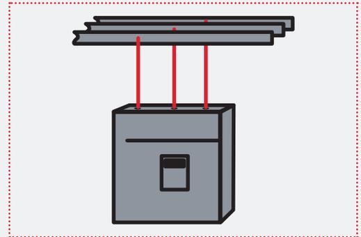
Connexions de jeux de barres et de composants électriques actifs (exemple : disjoncteur, contacteur), incluant la plupart des composants les plus compacts du marché
